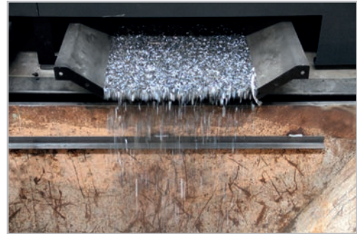
Chip evacuation Detalle evacuación escoria
