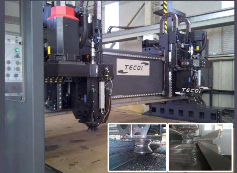
La machine TRF est la solution pour répondre aux besoins les plus exigeants en ce qui concerne les normes de préparations des bords à souder.
